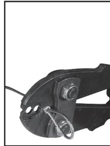
**Paso 2.** Colocar el casquillo en la herramienta usando la hendidura que mejor se ajuste de manera tal que al crimpear quede compactado al cable de acero. Repetir esta operación rotando el casquillo de modo tal que quede sin relieves.
